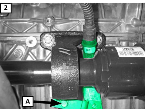
(SV) Rengör noga där värmaren ska installeras. Demontera skruv [A].
