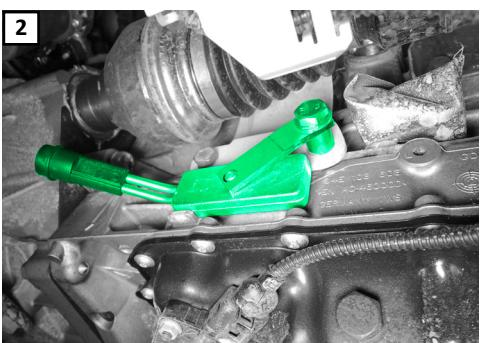
**FI** Irrota käyttöäkselin rakenteesta riippuen ruuvi **A** tai **B**. Kiukaan asennuksen jälkeen ruuvi ei saa koskettaa käyttöäkselia. Levitä tasaisesti lämpöä johtava pasta lämmittimen pintaan joka on kosketuksessa moottoriin. Lämmittimen kaapeli pistokkeineen veden täään etupuskurista moottori-tilaan ja moottorilämmittimeen.
