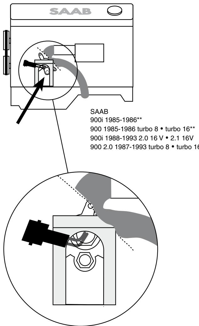
\*\* Är inte bilen utrustad med hydrauliska motorfästen skall värmare 186 användas.
