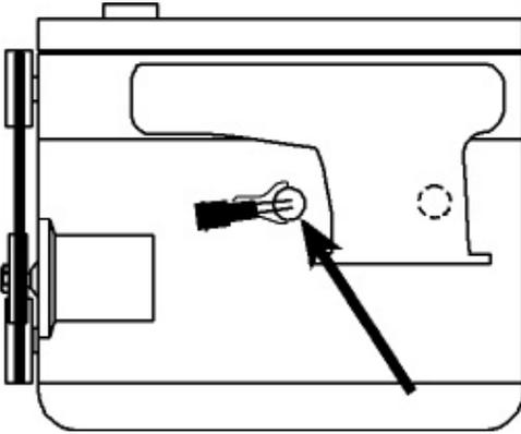
(SV) Tappa ur kylvätskan. Demontera tätningsbrickan som täcker det hål som utvisas på bild. Detta kan utföras genom att ett 8-10 mm hål borras mitt i brickan som därefter brytes bort med en dorn el. dyl. För in motorvärmaren i hålet och drag fast värmaren med de medföljande fästansordningarna. Fyll på kylvätska och lufta ur kylsystemet. Kör motorn varm och kontrollera att inget läckage förekommer.
