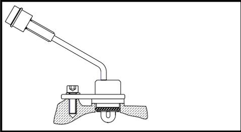
(DE) Kühlwasser ablassen. Verschluss der Bohrung im Motorblock herausnehmen, Bild. Dazu ein Loch von 8-10 mm in der Mitte der Verschluss bohren. Danach mit schmalen Werkzeug (Dorn) wegbrechen. Heizpatrone in das Loch einstecken und festziehen mit den beigelegten Einbaudetaillen. Wasser einfüllen und Kühlsystem lüften. Motor laufen lassen und Einbaustelle auf Dichtigkeit prüfen.
