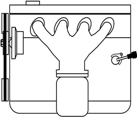
(SV) Tappa ur kylvätskan. Demontera tätningsbrickan som täcker det hål som utvisas på bild. Detta kan utföras genom att ett 8-10 mm hål borrar mitt i brickan som därefter brytes bort med en dorn el. dyl. För in motorvärmaren i hålet och drag fast värmaren med de medföljande fästnordningarna. Fyll på kylvätska och lufta ur kylsystemet. Kör motorn varm och kontrollera att inget läckage förekommer.
