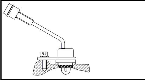
(DE) Kühlwasser ablassen. Verschluss der Bohrung im Motorblock herausnehmen, Bild. Dazu ein Loch von 8-10 mm in der Mitte der Verschluss bohren. Danach mit schmalem Werkzeug (Dorn) wegbrechen. Heizpatrone in das Loch einstecken und festziehen mit den beigelegten Einbaudetaillen. Wasser einfüllen und Kühlsystem lüften. Motor laufen lassen und Einbaustelle auf Dichtigkeit prüfen.
