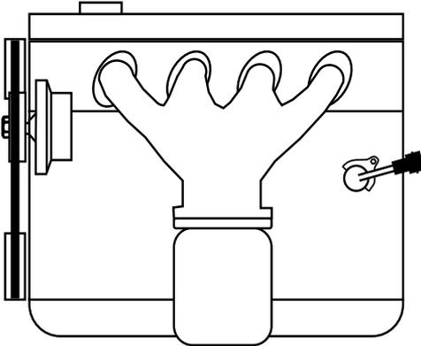
(SV) Tappa ur kylvätskan. Lossa de 2 skruvar som håller vattenröret. Kapa bort den markerade delen av fästet så att värmaren får plats. Demontera tätningsbrickan som täcker det hål som utvisas på bild. Detta kan utföras genom att ett 8-10 mm hål borras mitt i brickan som därefter brytes bort med en dorn el. dyl.
