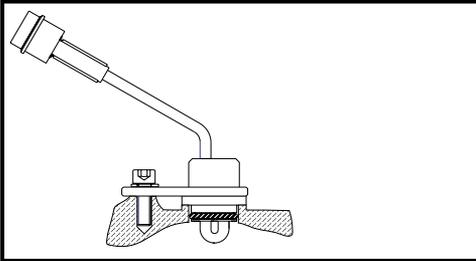
(SV) Tappa ur kylvätskan. Demontera tätningsbrickan som täcker det hål som utvisas på bild. Detta kan utföras genom att ett 8-10 mm hål borras mitt i brickan som därefter brytes bort med en dorn el. dyl. För in motorvärmaren i hålet och drag fast värmaren med de medföljande fästansordningarna. Fyll på kylvätska och lufta ur kylsystemet. Kör motorn varm och kontrollera att inget läckage förekommer.
