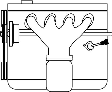
(SV) Tappa ur kylvätskan. Demontera tätningsbrickan som täcker det hål som utvisas på bild. Detta kan utföras genom att ett 8-10 mm hål borras mitt i brickan som därefter brytes bort med en dorn el. dyl. För in motorvärmaren i hålet och drag fast värmaren med de medföljande fästnordningarna. Fyll på kylvätska och lufta ur kylsystemet. Kör motorn varm och kontrollera att inget läckage förekommer.
