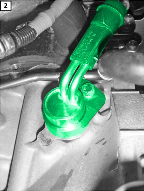
(SV) För in motorvärmaren i hålet och drag fast värmaren med de medföljande monteringsdetaljer. Fyll på kylvätska och lufta ur kylsystemet. Kör motorn varm och kontrollera att inget läckage förekommer.
