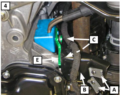
**(SV)** Placera medföljande distans [D] mellan plåtfäste [B] och översta hålet på motor och skruv [C]. Dra ej åt skruven.
