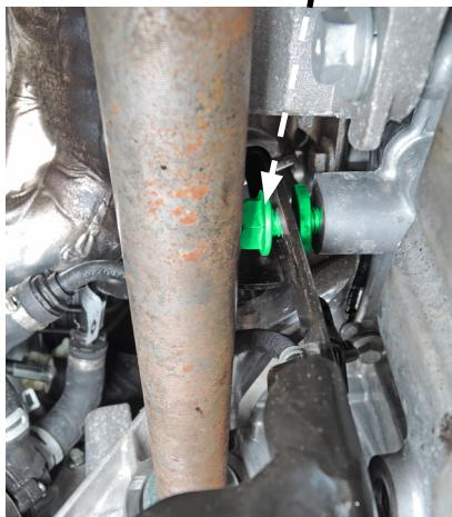
**SV** Demontera låsblecken [A] som håller pumpen på plats i plåten [B].
