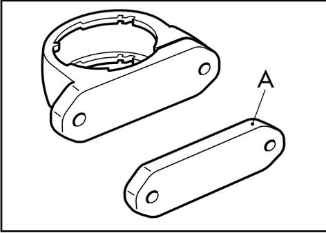
(SV) Distansen (A) används för att locket skall få frigång om kontakten monteras på en plan yta. De två kortaste skruvarna (16 + 19 mm) används när kontakten monteras utan distansen, de två längsta skruvarna (19 + 25 mm) används när kontakten monteras med distansen.
