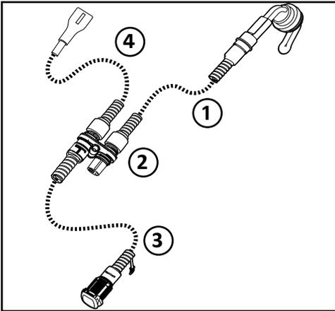
**DE** Das entsprechende Kabel 1 auswählen und am Motorvorwärmer montieren.
