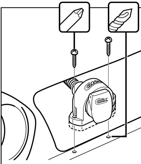
(DE) Der Abstandhalter (A) wird eingesetzt, um bei Montage des Anschlusses auf einer ebenen Fläche die freie Beweglichkeit der Abdeckung des Einbaukabels sicherzustellen. Die beiden kürzeren Schrauben (16 + 19 mm) werden zur Montage des Befestigungsblocks ohne Abstandhalter verwendet, die beiden längeren Schrauben (19 + 25 mm) werden verwendet, wenn der Befestigungsblock mit Abstandhalter montiert wird.
