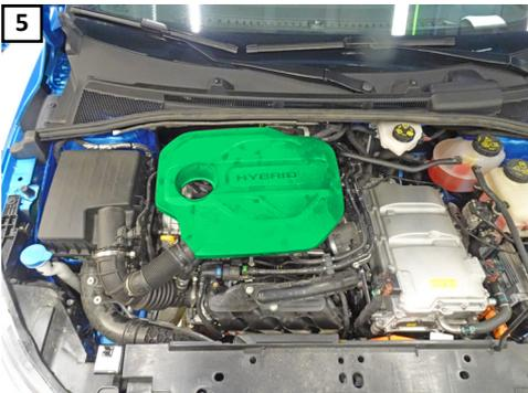
(SV) Återmontera motorkåpan, skyddet under motorn, luftfilter och insug.
